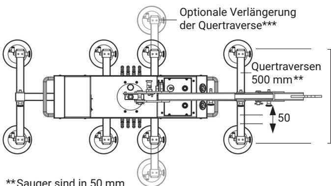
\*\* Sauger sind in 50 mm Abständen auf den vier Quertraversen verstellbar.
