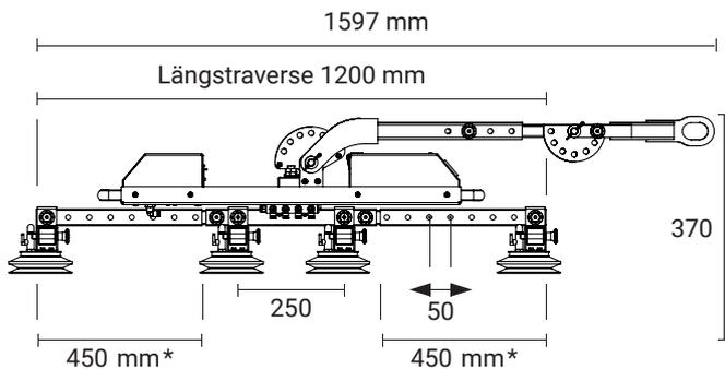
\* Auf der äußeren Längstraverse sind die Quertraversen in 50 mm Abständen verstellbar.
