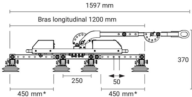
\*Sur le bras longitudinal extérieure, les bras transversaux sont réglables par pas de 50 mm.
